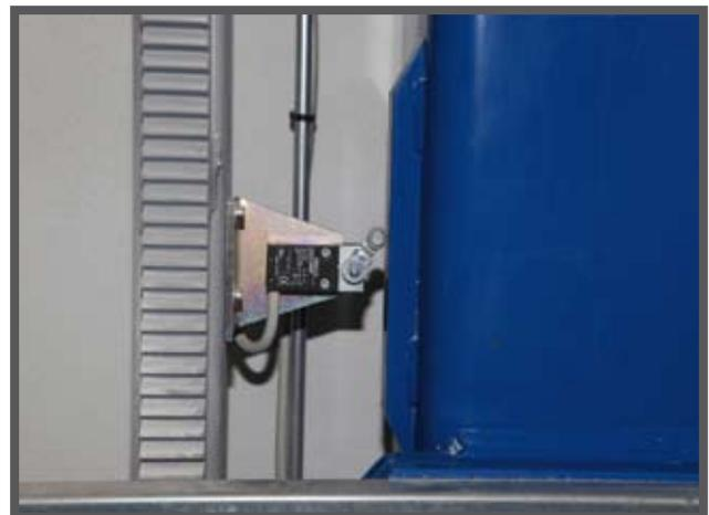
En bas, le fonctionnement du fin de course de ralentissement et de régulation de la course, mis en évidence par la longueur de la came d'actionnement (plus longue que la came d'arrêt).
