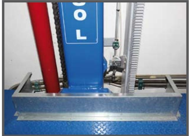
Cette photo, en revanche, montre le fonctionnement du fin de course d'arrêt, positionné sur la colonne opposée au fin de course de ralentissement, et identifiable par une came d'actionnement plus petite.
