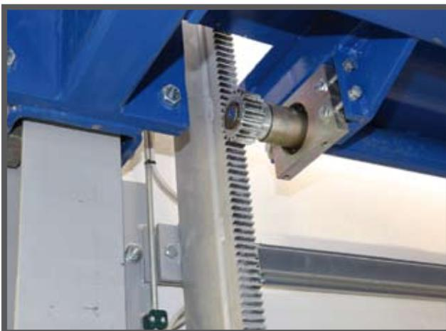
Le pignon de tête de la barre de torsion est doté d'un embout denté (un sur chaque extrémité) qui roule, à l'aide de l'accrochage, sur les crémaillères (une par colonne). Cette barre de torsion est dotée de supports dont la position est réglable, pour un accrochage optimal avec les crémaillères.
