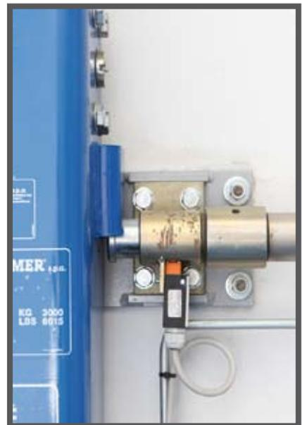
Sur l'ensemble de ces photos figure le système du taquet de blocage mécanique de la plateforme du niveau, qui utilise l'actionnement hydraulique.
